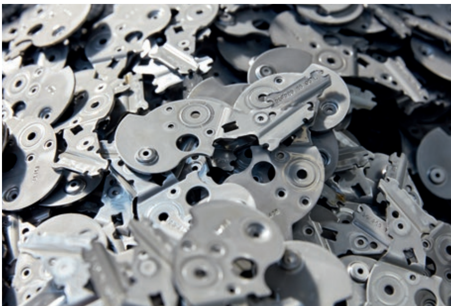
Die Feinstanz AG hat sich neben der Produktion von Feinschneid-Umformteilen auf Verzahnungen mit einem großen Glattschnittanteil und hoher Genauigkeit spezialisiert.
