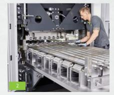
Das erweiterte Reinigungssystem vereinfacht das Reinigen der Richtwalzen und Stützrollen durch die vollständig ausfahrbare Richtkassette.
