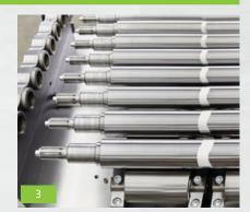
Patentierte wendbare Richtwalzen verlängern die Standzeit der Richtwalzen beim Richten von schmalen Teilen auf Maschinen mit vergleichsweise großer Durchlaufbreite.
