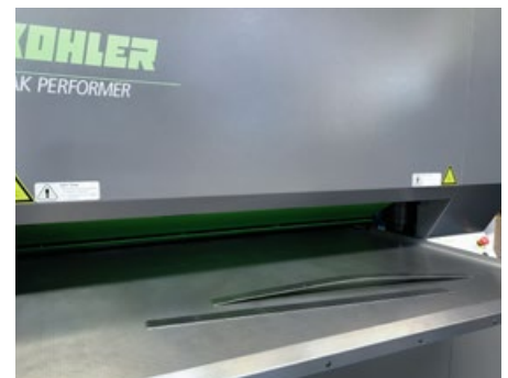
Vorher und Nachher: Die Teile sind nach dem Richten eben und spannungsarm (vorn) und lassen sich dadurch schneller und besser weiterverarbeiten. Das Ergebnis sind hochwertigere Produkte. Hinten ist zum Vergleich das ungerichtete Blech zu sehen.
